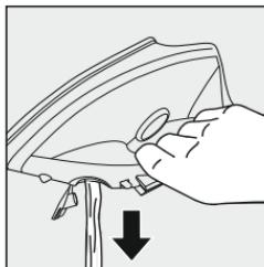
3. Наполните резервуар водой через специальное отверстие.
